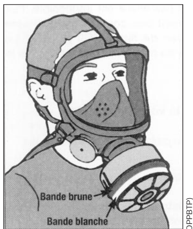
fig. 2 : Masque équipé d'un filtre anti-poussières et d'un filtre anti-gaz.
